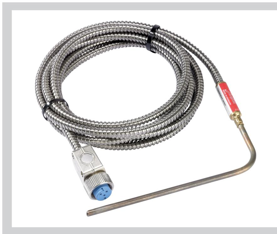
MBT 5111 — датчик температуры, предназначенный для тяжелых условий эксплуатации, который можно использовать для измерения и регулирования температуры выхлопных газов, выходящих из дизельных двигателей, турбин и компрессоров в стационарных установках и в судостроении. В данном датчике температуры используется термопара типа К, которая измеряет температуры до 800 °С. Компактная конструкция обеспечивает малое время реакции:  $t_{0.5} = 2$  с в воде.
